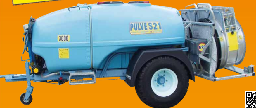
Version 4 turbines Ø 800 mm : 2 modules de 2 hélices à rotations inversées
